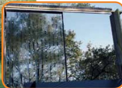
Essais dans un canal de vol installé dans le jardin de la Station ornithologique suisse, en collaboration avec Glas Trösch. Ici, on teste des marquages UV sur des vitres anti-solaires.
