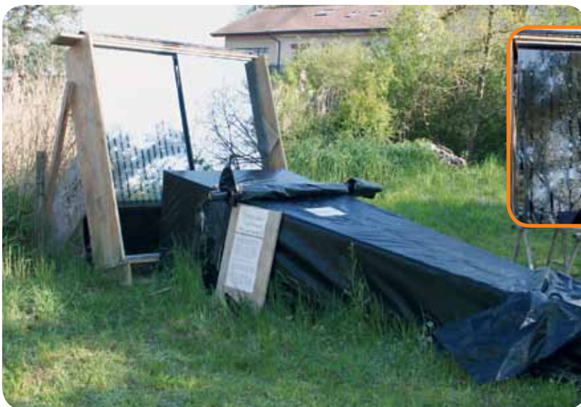
Essais dans un canal de vol installé dans le jardin de la Station ornithologique suisse, en collaboration avec Glas Trösch. Ici, on teste des marquages UV sur des vitres anti-solaires.
